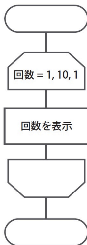
図 6 1. 1 から 10 の数字を出力するプログラムのフローチャートを、ループの図記号を使って描く
